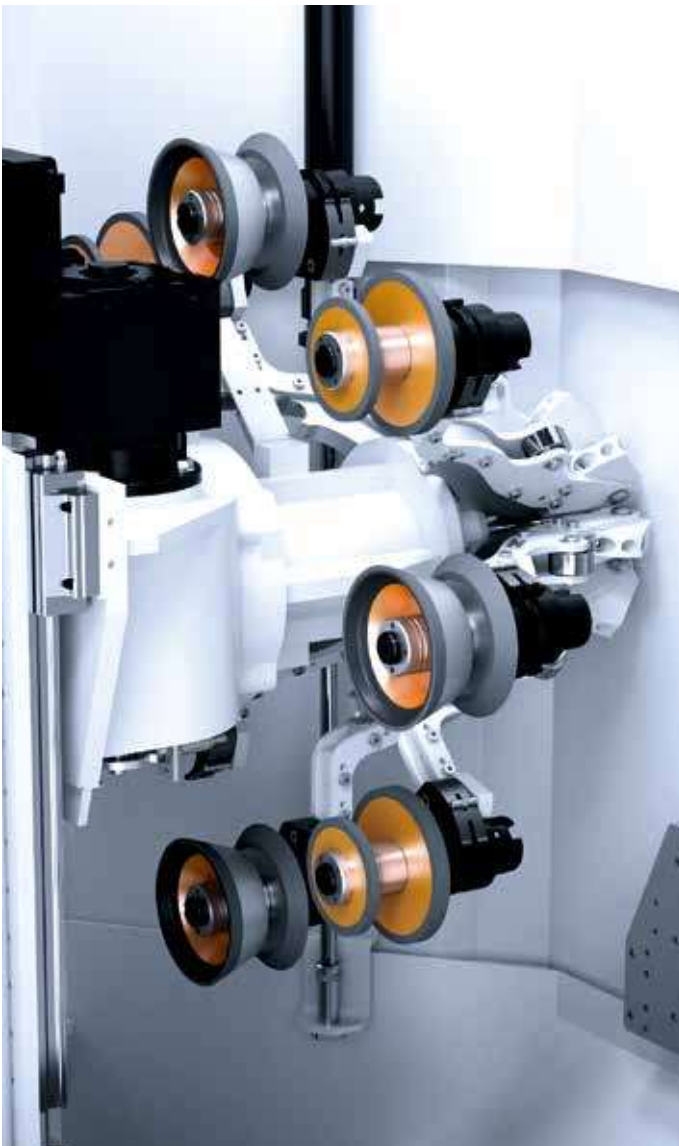
/// 8連マガジン 工具の効率的な交換と換装時間の短縮を実現
