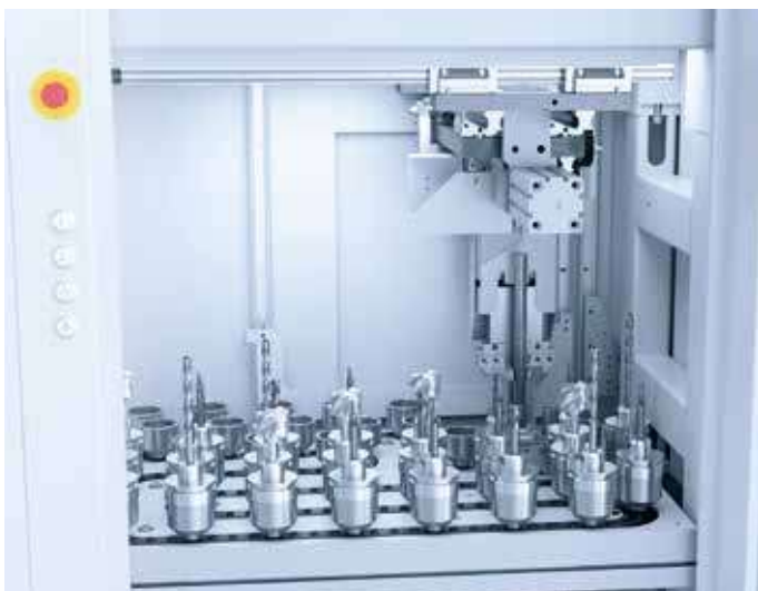
//// チェーンマガジン HC 4 39個のHSK-A63A 用の工具を乗せる事が可能。
