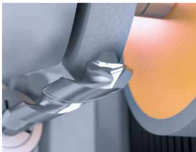
/// 超硬ドリルの加工
